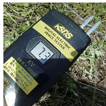
電圧チェッカー
