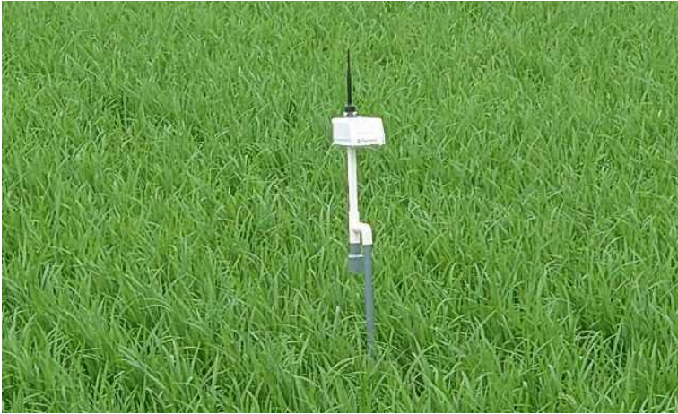
導入した水位センサー(farmo)(左)と スマートフォンの表示例(右)
