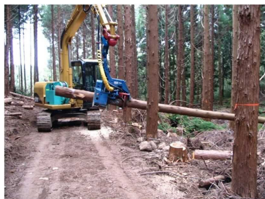
高性能林業機械による搬出間伐
