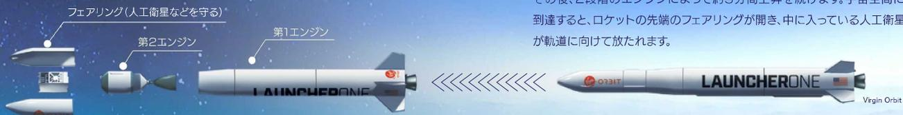
人工衛星を宇宙まで運ぶのは、ランチャー・ワンと呼ばれるロケットです。コスミック・ガールによって上空に運ばれ、高度10,000mで切り離されます。その後、2段階のエンジンによって約9分間上昇を続けます。宇宙空間に到達すると、ロケットの先端のフェアリングが開き、中に入っている人工衛星が軌道に向けて放たれます。
