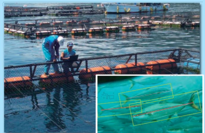
ICTを活用した養殖ブリの自動体測システム
