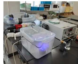
図7. 高電圧インパルスによる果実表面の殺菌(予備試験)
