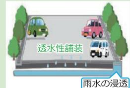
駐車場の透水性舗装による雨水の浸透
