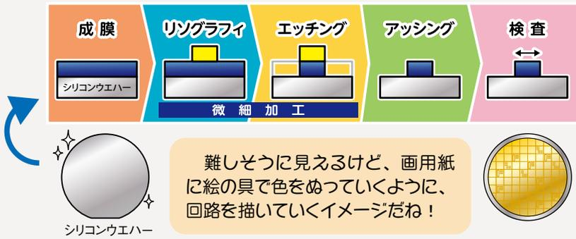
シリコンウエハーの上に薄い膜をつくり、リソグラフィ（露光）やエッチング（表面加工）といった微細加工などを行うことで、半導体の回路を作成する工程です。その回路は、ナノメートル（nm）単位の幅でつくられており、例えば1nmは1メートルの10億分の1、髪の毛の太さの10万分の1というくらい（はげ）の微細な幅となっています。
