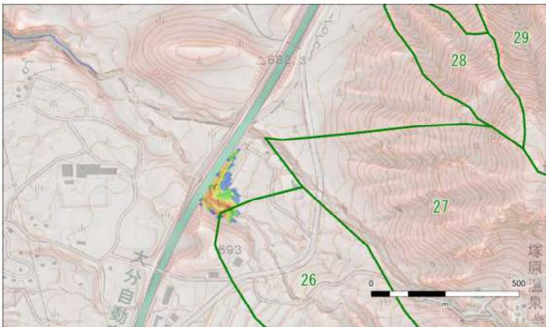
図 4.78 降灰後の土石流シミュレーション計算結果 (2年超過確率規模 ; No. 25、26)
