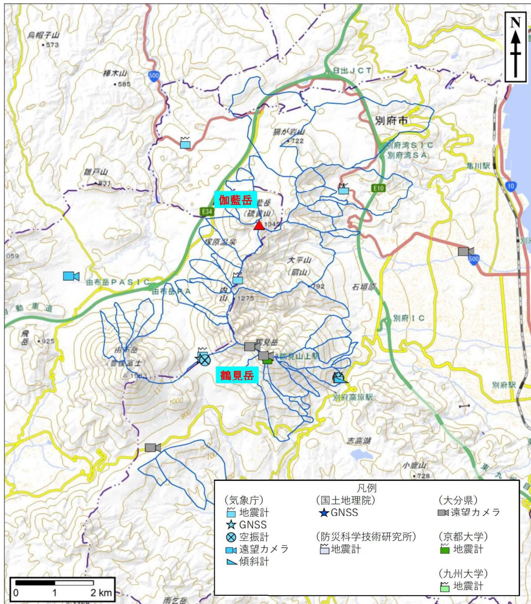
図 3.13 鶴見岳・伽藍岳周辺に設置されている火山監視観測機器分布図（近傍）
