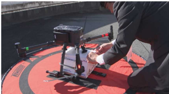
スマートキーボックスに入れた医薬品をドローンに搭載
