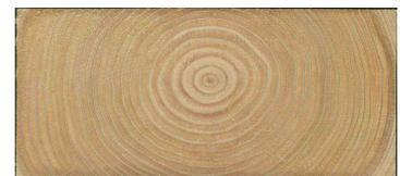
写真1 高周波減圧乾燥材の断面(表面割れ、内部割れもほとんどない)
