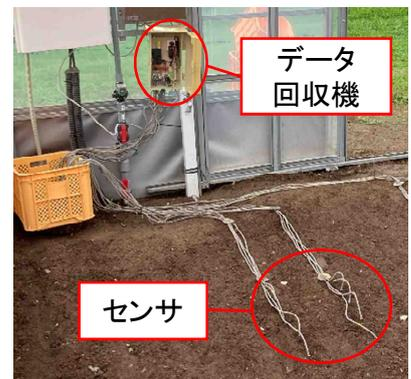
写真1 センサ設置状況(有線型)
