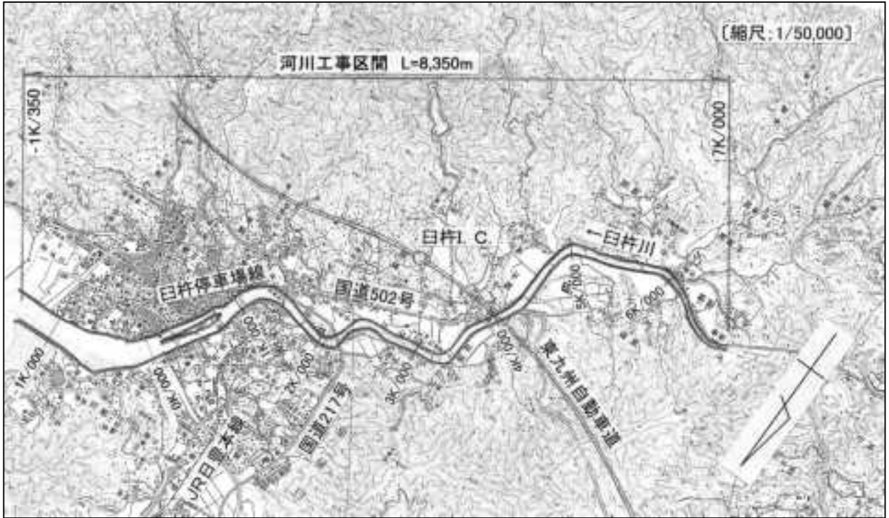
図4 河川工事の施行の場所
