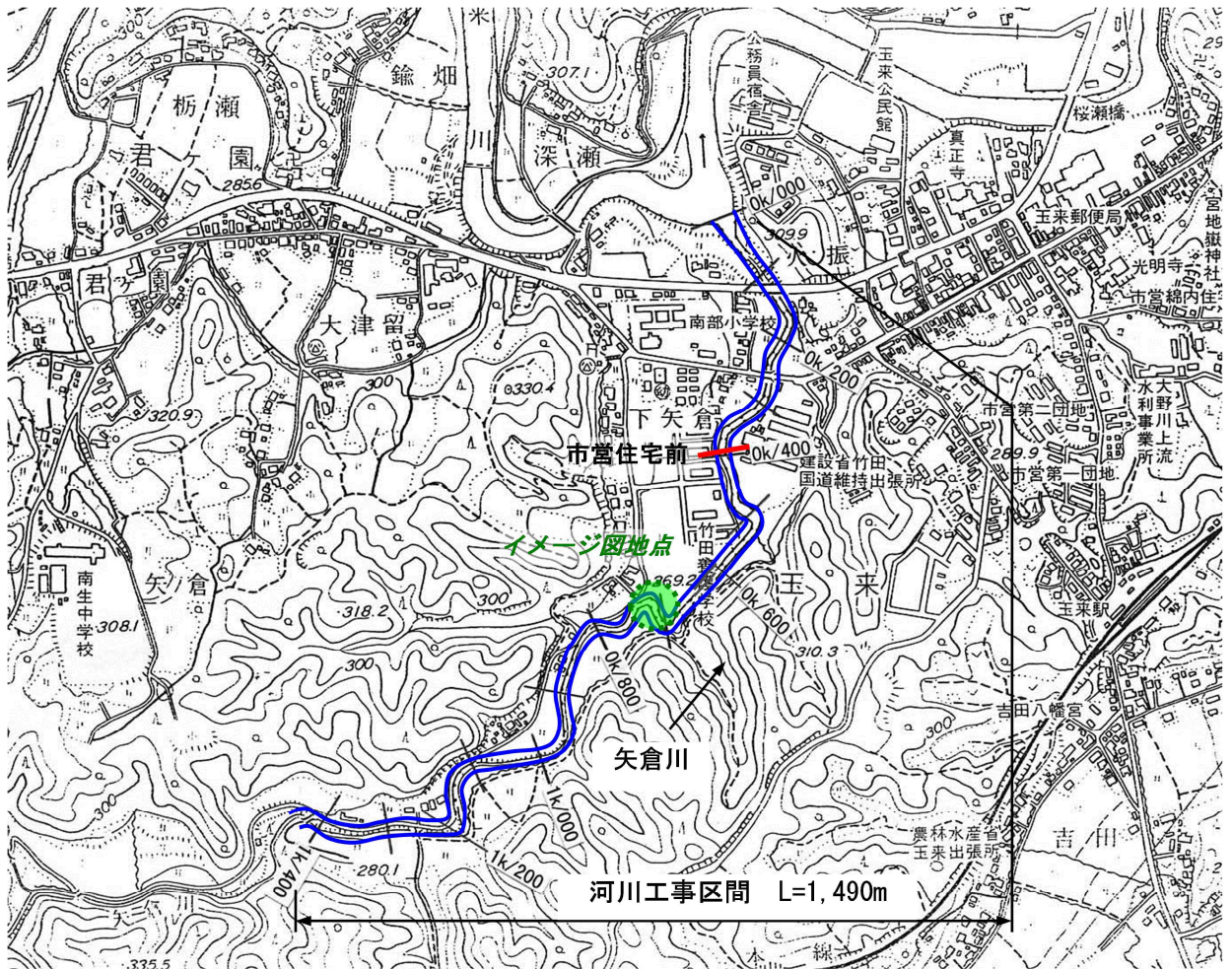
図 4-10 河川工事の施工の場所（竹田市大字 下矢倉）
