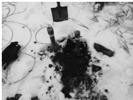
(左) 写真 2 現地で使用した電極の設置状況
