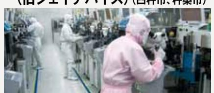
国内最大級の後工程の一貫工場で、半導体の組立を行っています。
