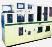
モールド樹脂でカバーされたチップをフレームから切り離し、完成品にする装置を作っています。
