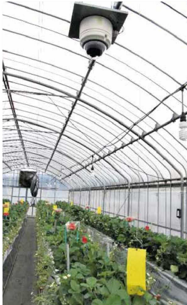
▲イチゴ大規模経営体を支援・育成する生産システムの確立 画像解析カメラによる出荷予測
