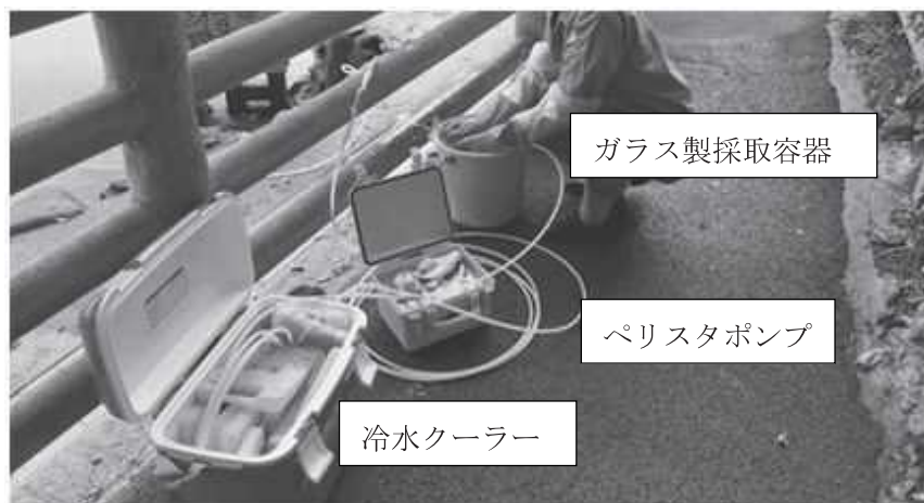
図2. かまど5丁目の希ガス分析用温泉水試料採取の様子. 長さ約30mのチューブの先端を池に投げ入れて、ペリスタポンプで温泉水をくみ上げた。採取容器の直前でチューブを冷水中にくぐらせて、およそ45°C程度まで冷却した。
