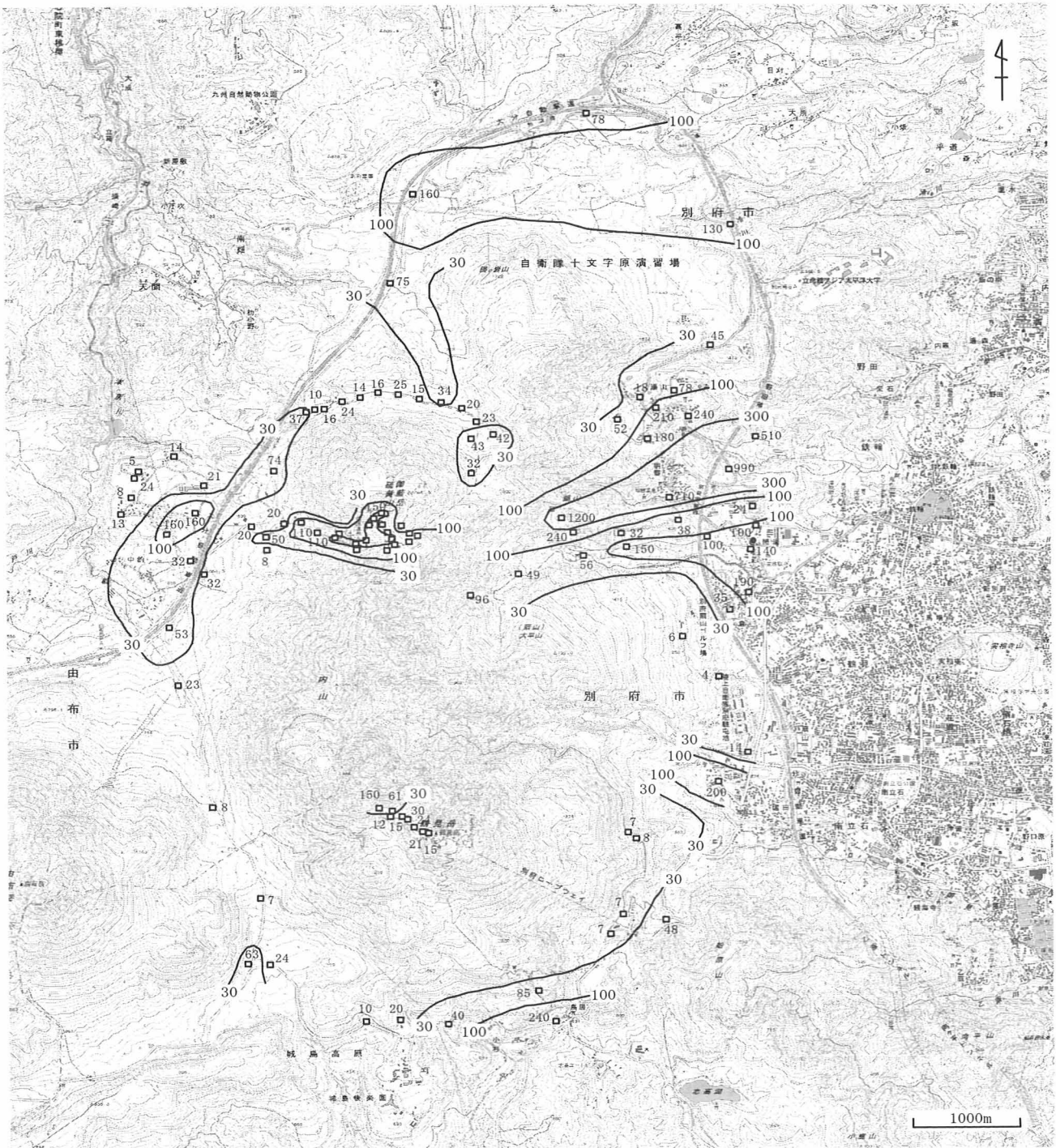
図1 VLF-MTによる鶴見岳・伽藍岳周辺の電気伝導度分布 (単位は \mu\text{S}/\text{cm} )
